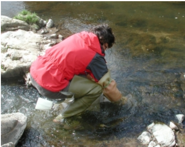
Fig. 10. Uso della rete Surber in condizioni di scarsa velocità di corrente.
