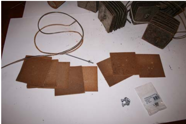
Fig. 1. Lamelle di faesite grezza di 10 x 10 cm di lato, forate al centro.
