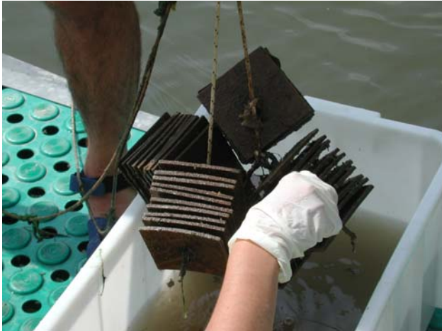
Fig. 12. Trasferimento degli SA in un apposito contenitore per il risciacquo e l'asportazione degli organismi dagli SA.
