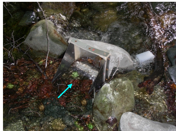
Fig. 5. Posizionamento della rete Surber per il campionamento. La freccia blu indica la direzione del flusso.
