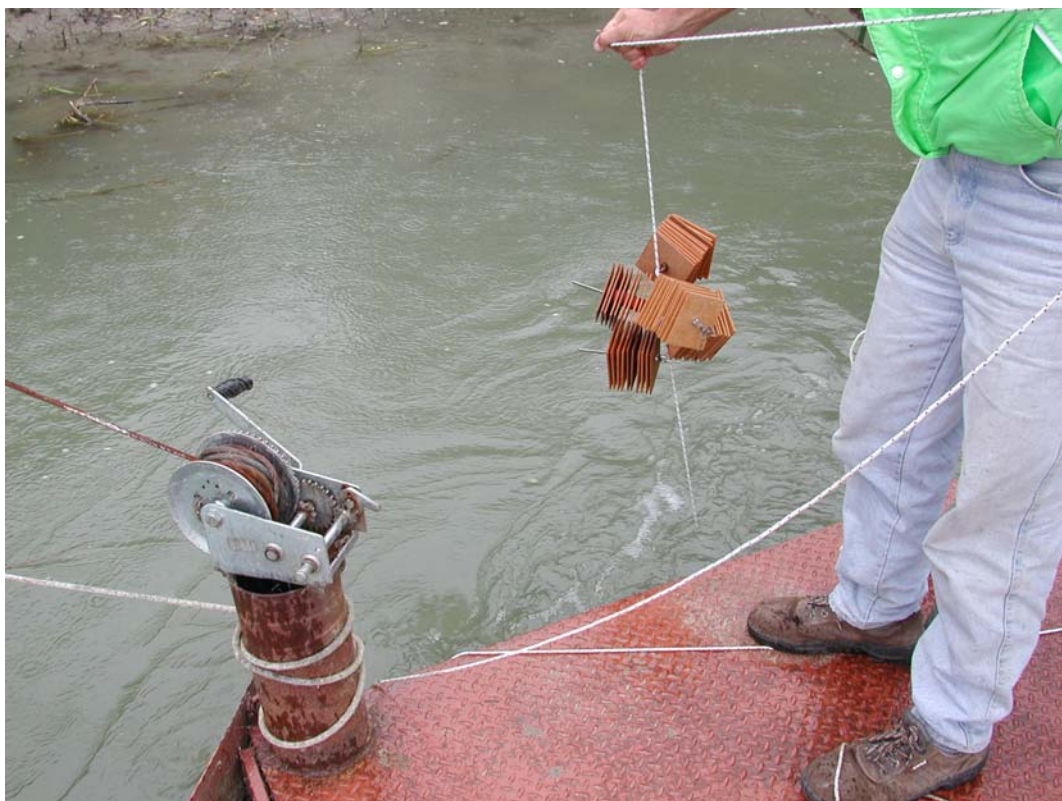
Fig. 8. Ancoraggio e posizionamento di un gruppo di SA su un pontile.
