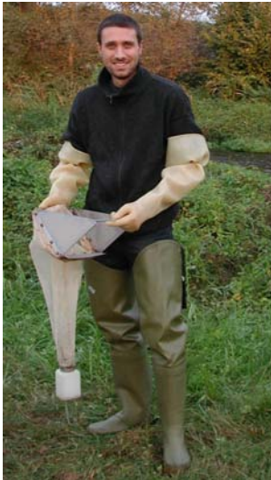
Fig. C 1. Abbigliamento da campionamento (con stivali tutta coscia, guanti e elastici per fermare i guanti)
