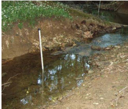
*Fig. 11- Esempio di miniwell per il campionamento dell'acqua iporreica e per la misura di parametri idraulici (foto IRSA).*
