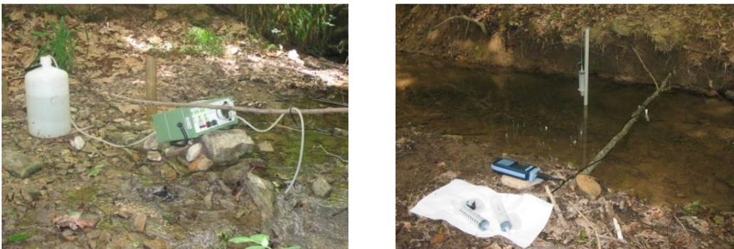
*Fig.8 - Due fasi dell'esperimento di aggiunta di nutrienti nel torrente Curone (progetto IRSA-CNR): aggiunta della soluzione con pompa peristaltica e misura delle variazioni di conducibilità 100 m a valle (foto IRSA).*
