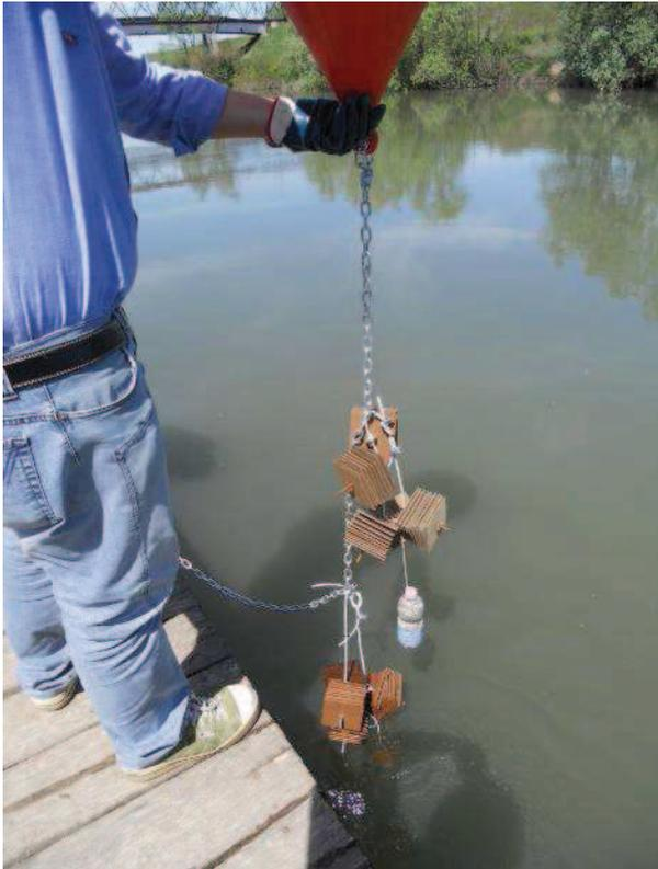
Fig.13. Posizionamento di substrati ancorati a boa da pontile, fiume Bacchiglione, Correzzola (PD)
