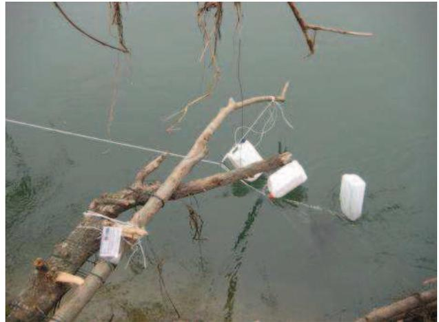
Fig.27. Ancoraggio con paletto distanziatore, sul fiume Bacchiglione Saccolongo (PD).
