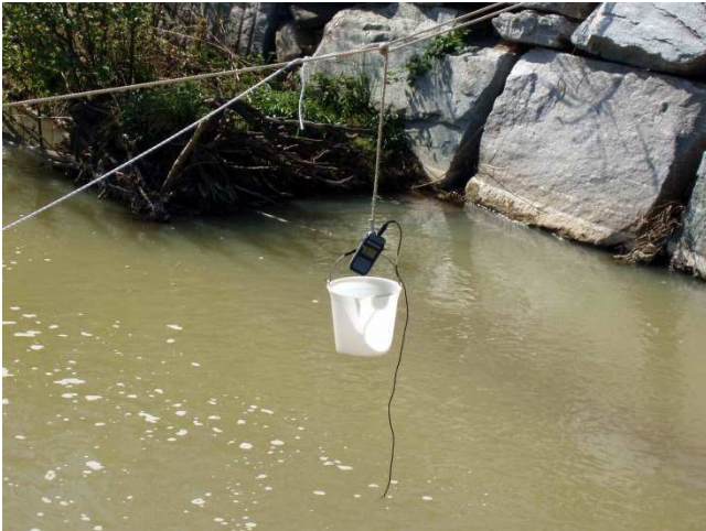
Figura 9. Misura della conducibilità 100 m a valle dal punto in cui si aggiunge la soluzione.
