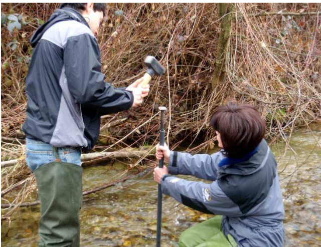
Figura 5. Installazione dei mini-piezometri.
