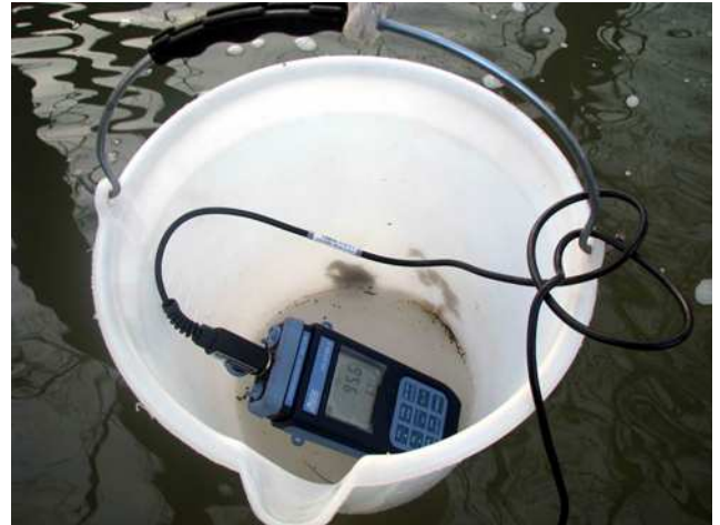
Figura 10. Conduttimetro dotato di data logger per la misura in continuo della conducibilità durante l'esperienza di aggiunta.
