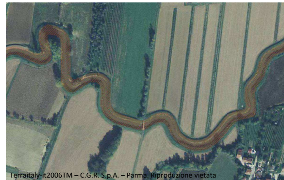
Figura 2. Digitalizzazione di un alveo fluviale con limiti esterni posti in corrispondenza del banktop (qui sommità argine); da tali poligoni sono state ricavate le linee spondali di banktop.
