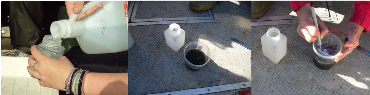
Fig. 1.1.5 - Trattamento dei campioni per analisi biologica: particolare relativo all'aggiunta di fissativo e all'etichettatura dei campioni.
