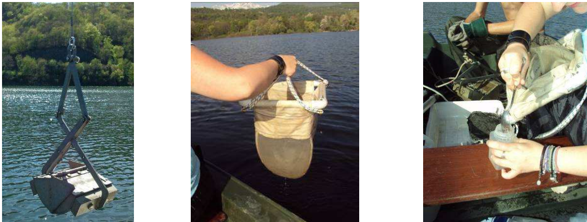
Fig. 1.1.4 - Trattamento dei campioni per analisi biologica: particolare della draga utilizzata, del risciacquo e del trasferimento del campione nei barattoli.
